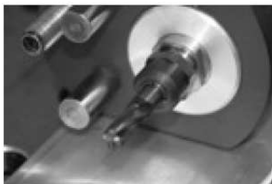
Stopková fréza, 8 mm, pro přípravek k prizmatickému frézování
